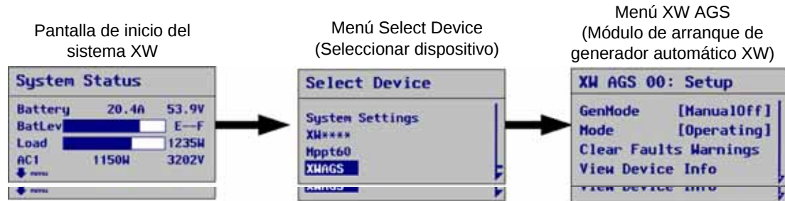
Figura 4-2 Arranque y detención del generador
