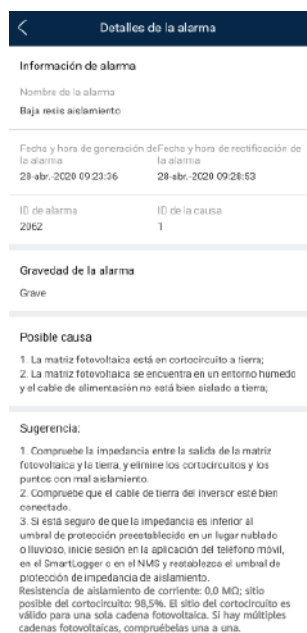
Figura E-1 Detalles de alarma
