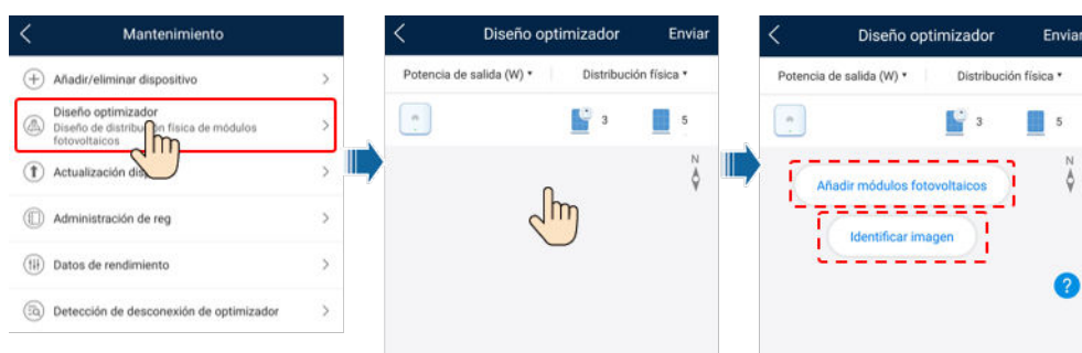
Figura 7-8 Diseño físico de los módulos fotovoltaicos
