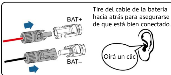
Terminales de la batería (BAT+/BAT-)
